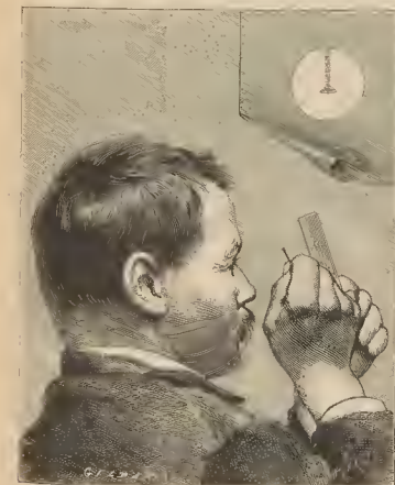
Fig. 1. — Modo de obtener la imagen invertida de un alfiler. En la parte superior del grabado, el aspecto de la imagen invertida.
